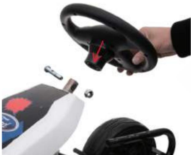
Kvôli viacerým pohyblivým častiam konštrukcie pod volantom sa môže stať že sa diery volantu a tyče riadenia neprekryjú. V takom prípade uchopte jednou rukou tyč riadenia pod karosériou autíčka pre uľahčenie upenenia volantu pomocou skrutky a matice. (podľa ilustračnej fotky)
